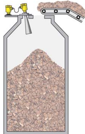
Obr.2 Zásobník dřevní štěpky s instalovaným hladinoměrem Vegapuls 68 a zobrazovací jednotkou Vegadis 61
