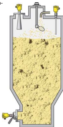
Obr.1 Bělicí věž pro výrobu papíru vybavená hladinoměrem Vegapuls 68 a převodníkem tlaku Vegabar 54 s limitní sondou Vegacap 64
