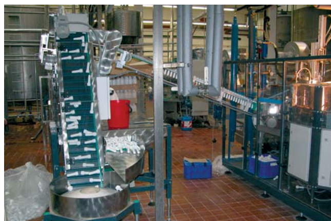
Zásobník s predliskami a dopravným zariadením do vyfukovačky
