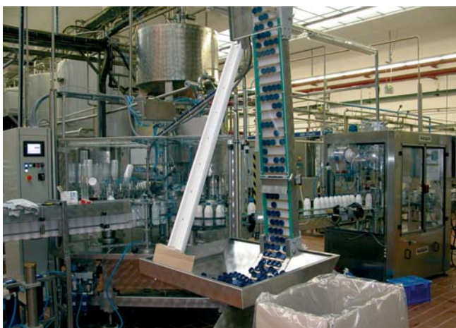
Zásobník plastových skrutkových uzáverov s dopravníkom do monobloku
