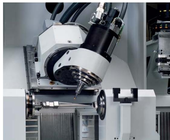
Nové centrum opracovania zhotovuje lopatky nielen rýchlejšie, ale aj vo vyššej kvalite ako predchodca
