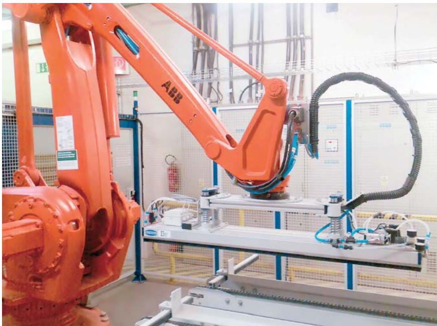
Obr.2 Rovnaký typ robota odoberá zlisovaný polotovar a ukladá ho na pripravenú paletu
