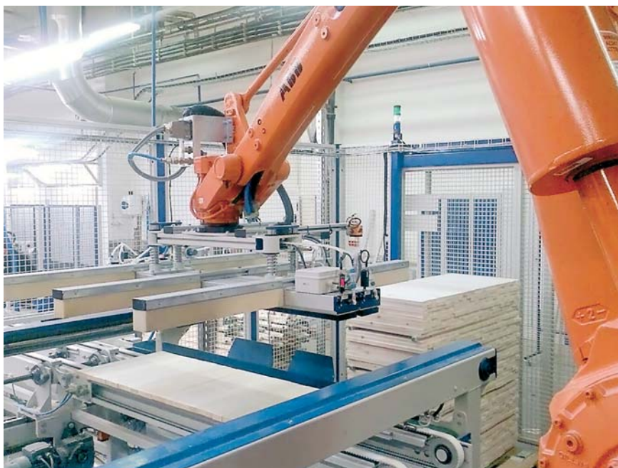
Obr.1 Robot IRB 660 vybavený gripprom nakladá polotovar – lamely na pás dopravníka
