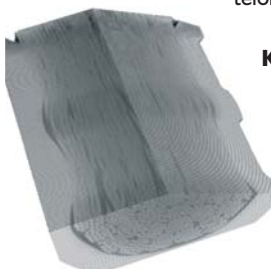
Röntgenová snímka krimpovacieho spoja
