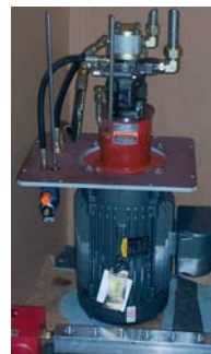
Nový dizajn čerpadiel, ktorý zabezpečil, že každé čerpadlo má samostatný elektrický motor
