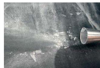
Obr.4 Automatické čistenie antény radaru pomocou stlačeného vzduchu
