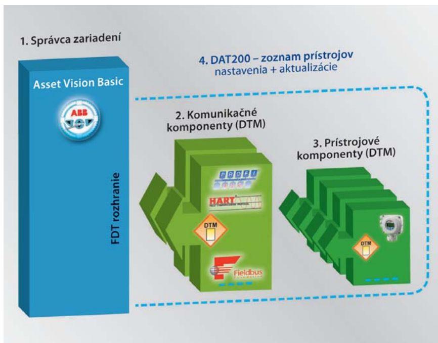
Obr.4 Dátová štruktúra systému Asset Vision Basic
