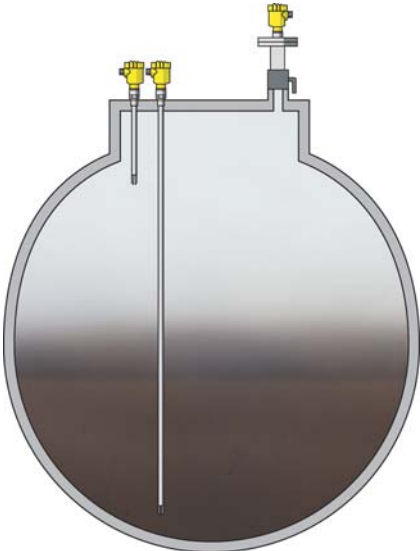
Obr.1 Měření hladiny v kulovém zásobníku: limitní spínače VEGASWING 63 a radarový hladinoměr VEGAPULS 68
