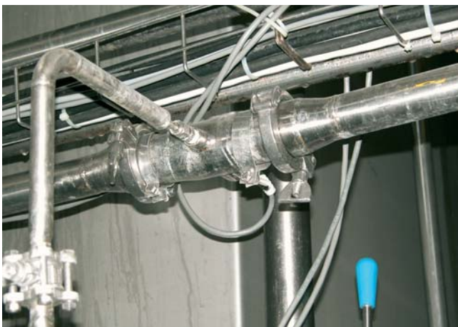
Brixmeter na meranie podielu refraktometrickej sušiny v sójovom mlieku, ktoré je súčasťou sójovej kaše
