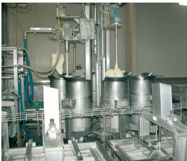
Zrážací a lisovací automat na výrobu tofu
