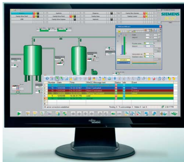
Obr.2 Náhľad na inovované operátorské rozhranie SIMATIC PCS7 v7.1 s novými ovládacími prvkami a blokmi APL
