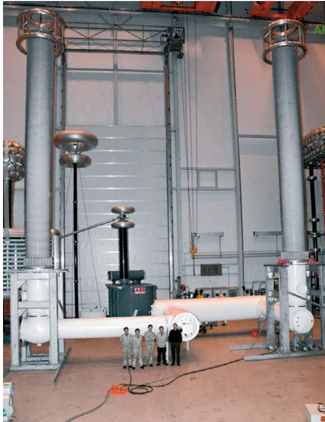
Odpojovač počas typových skúšok v laboratóriu STRI
