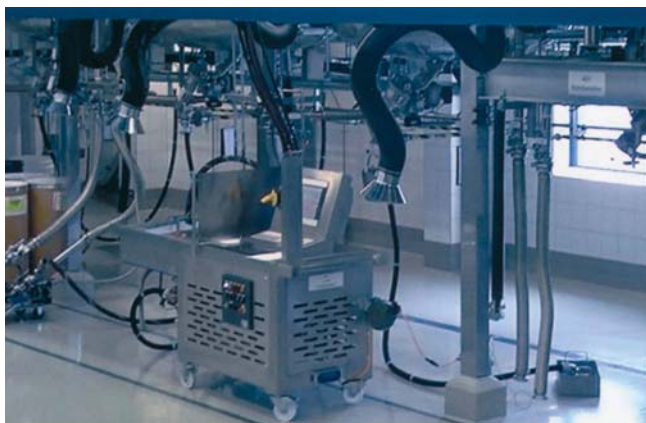
Mobilná stanica pri dispergačnom stroji je vybavená klávesnicou s integrovaným skenerom, touchpadom a príslušným monitorom do prostredia s nebezpečenstvom výbuchu
