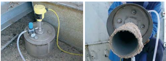
Kuželové antény s ofukom stlačeným vzduchom
