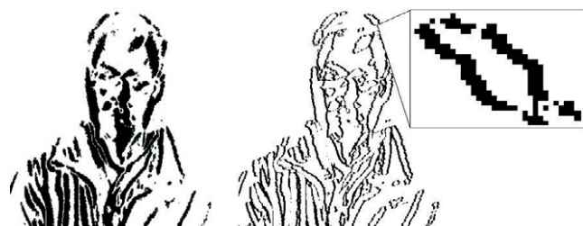
Obr.1 Binárny obraz (vľavo) a jeho detegované hrany po aplikovaní operátora Laplacian (vpravo) spolu so zobrazením detailu jednej hrany
