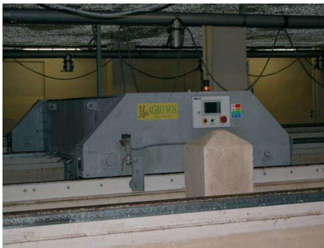
Pohľad na ovládací displej (PLC) obracacieho stroja Saladinovej skrine v klíčiarne
