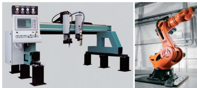
Obr.2 Príklady elektromechanických systémov: CNC rezací stôl, priemyselný robot s piatimi stupňami volnosti
