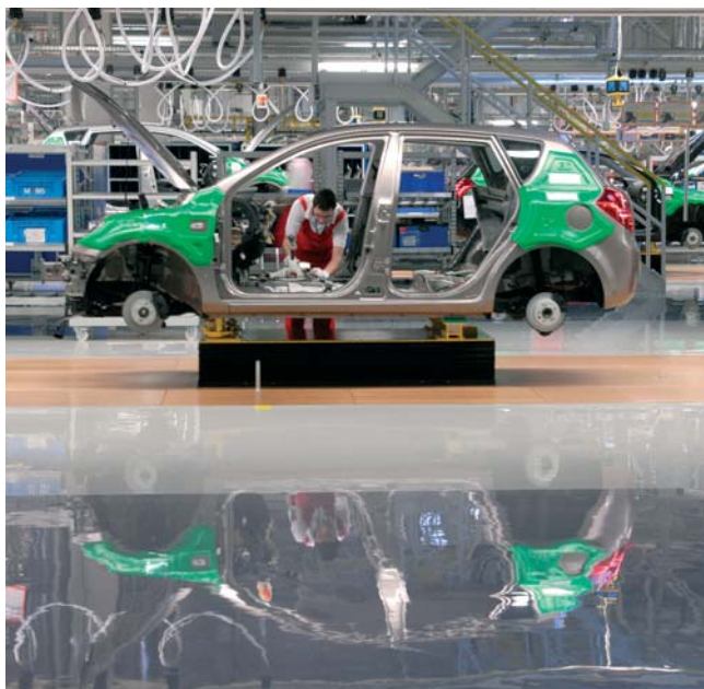
Obr. 1 Skylet („hnedá podlaha“) má v strede nožnicový zdvíhák, na ktorom je prichytená karoséria
