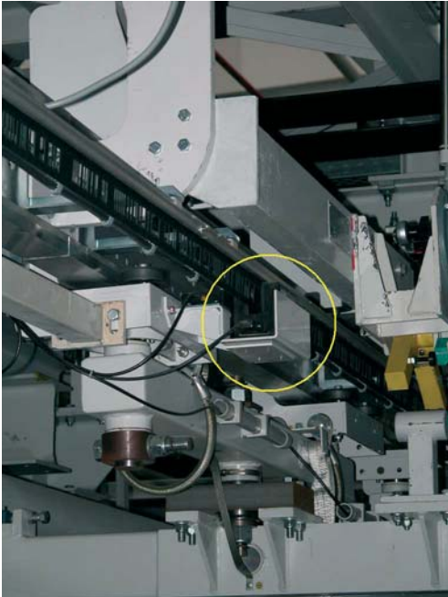
Obr. 2 Snímacia VCS hlava sa pohybuje po dierovanej kódovej lište
