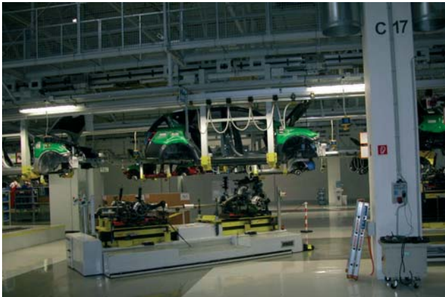
Obr. 4 Vozík prichádza na miesto, kde sa jeho pohyb synchronizuje so závesom nesúcim karosériu
