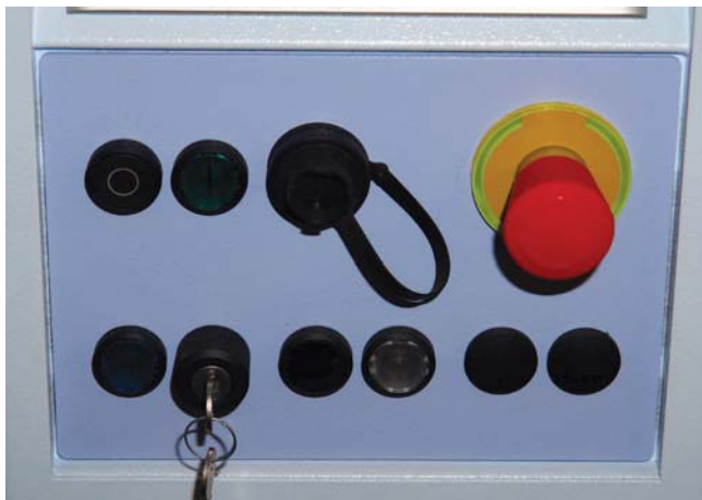
Tlačidlo núdzového zastavenia je vybavené svetelným signalizačným prstencom, ktorý môže v závislosti od prevádzkového stavu stroja svietiť zeleno, blikať, resp. nemusí vôbec svietiť
