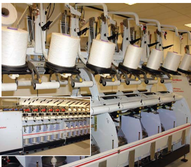
Spriadacie stroje CompactTwister od firmy Oerlikon Saurer zušľachtujú mechanickým spôsobom spriadaním jednoduché vlákna na vysoko pevné nite
