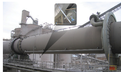
Obr. K najnovším prírastkom úplne zálohovanej komunikačnej trasy s protokolom WirelessHART v architektúre Smart Wireless od spoločnosti Emerson patria zálohované bezdrôtové V/V, zálohované napájanie a komunikácie a zálohované zariadenia Smart Wireless Remote Link.
