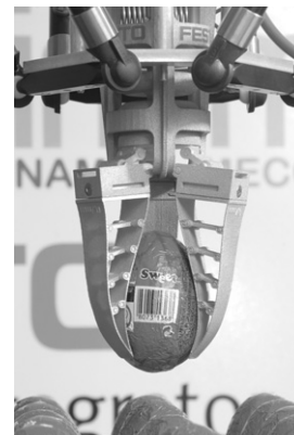
FinGripper schopný uchopiť krehké čokoládové vajíčko
