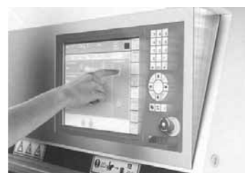
Obr. 3: Operátorské rozhranie tvorené dotykovým displejom
