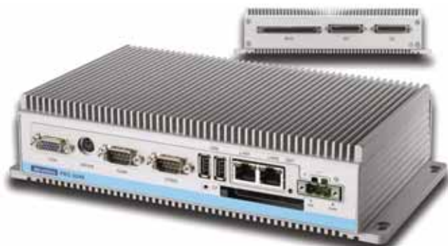
Obr.1: Embedded PC riadiaca jednotka pre servopohony s krokovými motormi ADVANTECH PEC-3240
