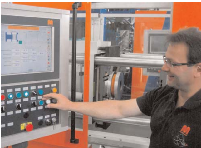
Obr.4 Vizualizovaný systém beží na ergonomicky upravenom, zákaznícky navrhnutom AP900 Automation Panel od B&R s 15“ dotykovým displejom.
