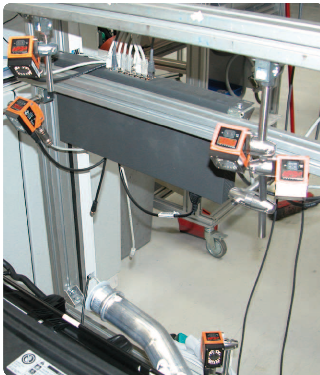
Obr. 3 Päťka snímačov na snímanie a spracovanie obrazu na výstupnej kontrole
