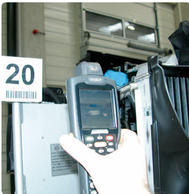
Obr. 4 Kontrola pozície modulov na transportnom vozíku
