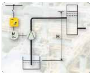
Obr. 2.: regulácia prietoku otáčkami motora
