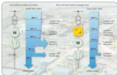
Obr. 3.: porovnanie spotreby energie – regulácia škrténím a frekvenčným meničom (Zdroj ZVEI)
