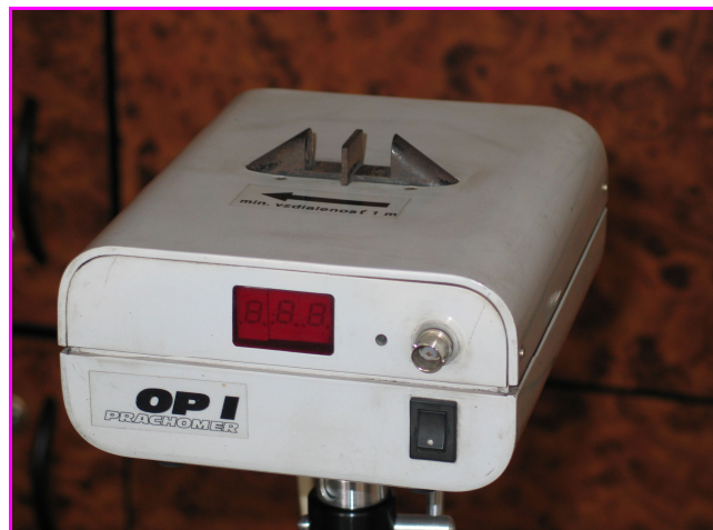
Obr.1 Prachomer OP1 pracujúci na princípe rozptylu svetelného žiarenia prachovými časticami
