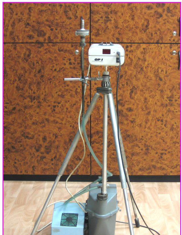
Obr.4 Merací reťazec pre kalibráciu optického prachomera
