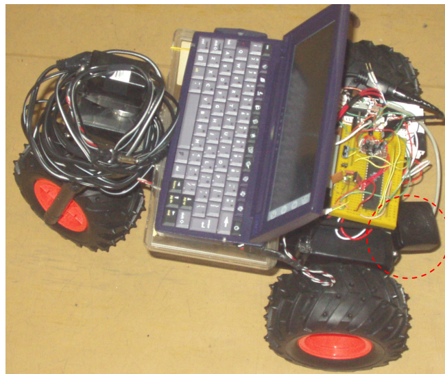
Obr.6 Mobilný robot s GPS zariadením Fig.6 Mobile Robot with GPS System
