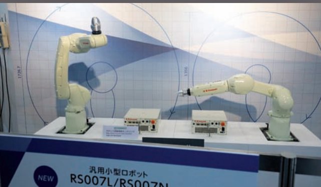
Novinky z oblasti malých robotov – Kawasaki RS007N a RS007L s F60, najmenším riadiacim modulom. Malé, spoľahlivé a veľmi rýchle roboty do nosnosti 7 kg s dosahom 705 a 930 mm.
