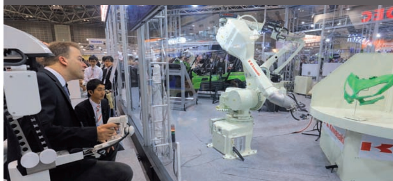
Komplexné riešenie pre operátorom navádzané robotické operácie rôzneho druhu a s adaptívnym učením trajektórie robota – Kawasaki Successor
