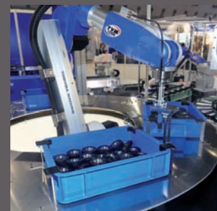
Šesťosový robot Toshiba Machine TVM v aplikácii Bin Picking využívajúci SW produkty TSAssist a TSVision3D – štandardné, cenovo dostupné riešenie
