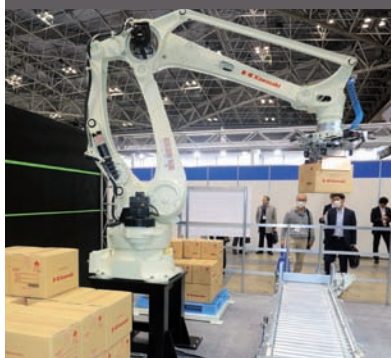
Kawasaki CP 180 – paletizačný robot, extra rýchly až do 2 500 cyklov/hod. a ekologický – šetrí až do 40 % elektrickej energie
