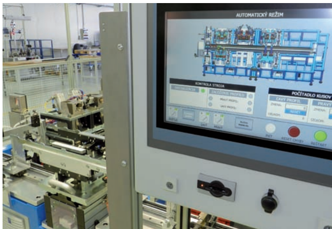
Cez ovládací panel si operátor volí druh spracúvaného profilu či režim zariadenia – automatický alebo manuálny
