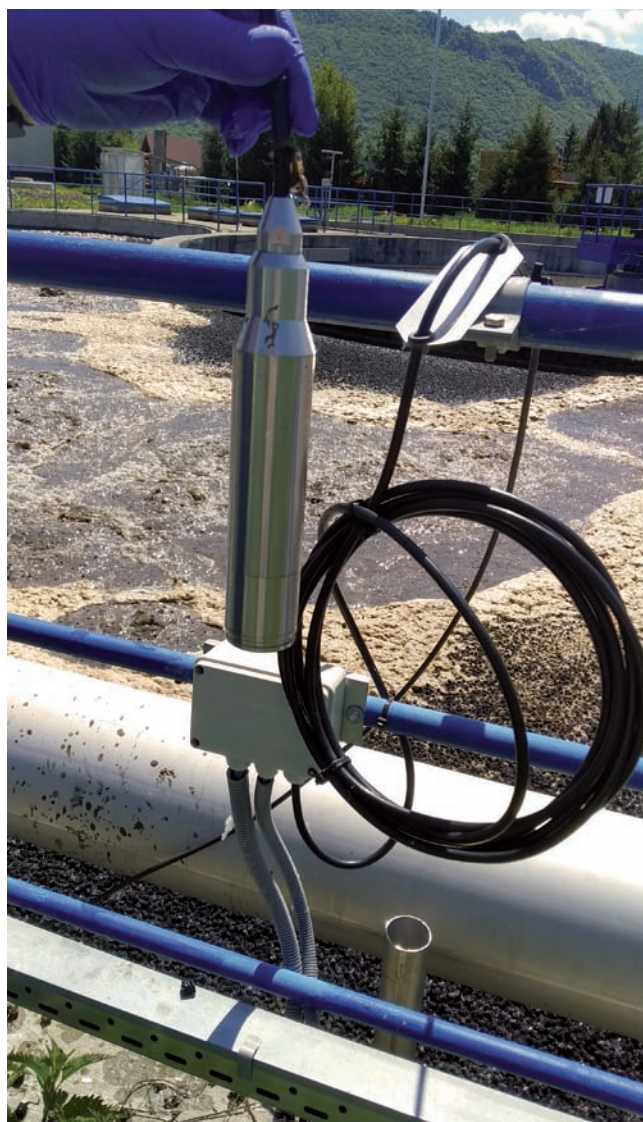
Meranie výšky hladiny hydrostatickým ponorným snímačom hladiny spoločnosti Nivelco
