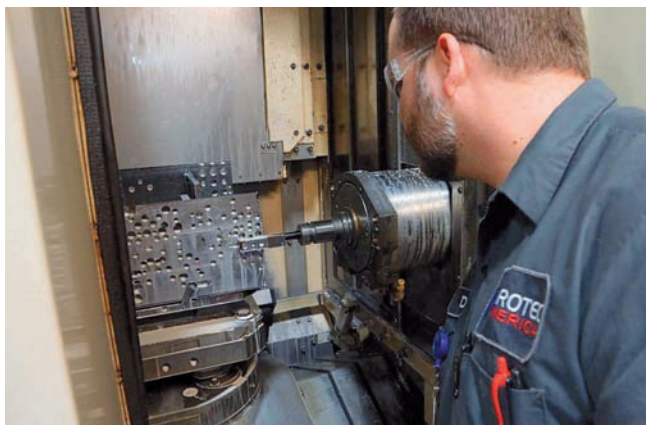
Tieto CNC stroje obsahujú niekoľko dátových záznamov vytváraných v reálnom čase, ako je napr. posuv, trajektória nástroja, smer a rýchlosť servomotorov.
