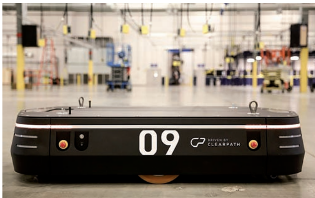
Autonómne vozidlo OTTO 1500 na prepravu ťažkého materiálu v skladoch, distribučných centrách a továrňach (Foto: Wikipedia)
