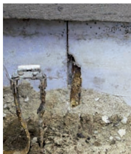
Poškodenie uzemňovača z pásoviny FeZn. Uloženie v zemi 5 rokov.
