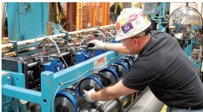
Meniť rezacie nože manuálne môže byť nebezpečná operácia.
