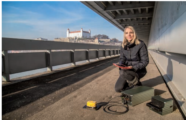
Meranie kmitania veľkej mostnej konštrukcie vyžaduje špecializovanú meraciu techniku.
