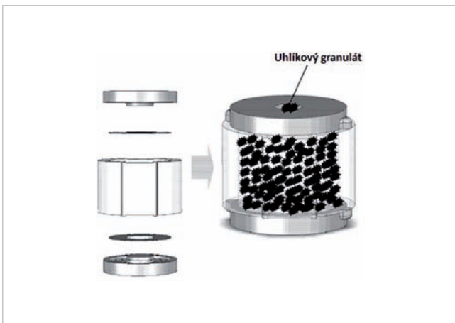
Obr. 5 Zapuzdrená patróna s uhlíkovým granulátom
