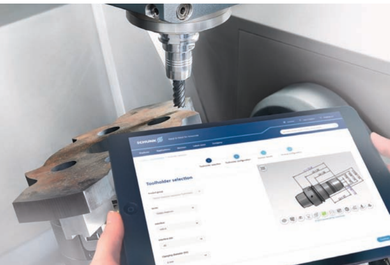
Hydraulické expanzné upínače nástrojov možno flexibilne prispôsobiť v ich geometrii, rozhraní a upínacom priemere.
