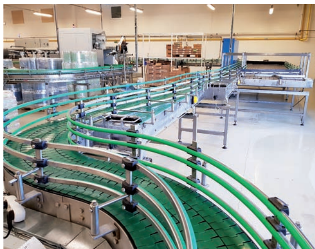
Dopravníkové prechody, vstup do akumulácie
