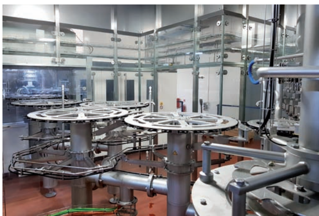
Transferové hviezdy spájajú vyfukovací stroj priamo s plniacim.
