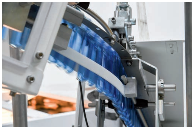
PET predlisky sa v peci nahrejú a pod tlakom vyfúknú do finálneho tvaru a rozmeru fľaše.
