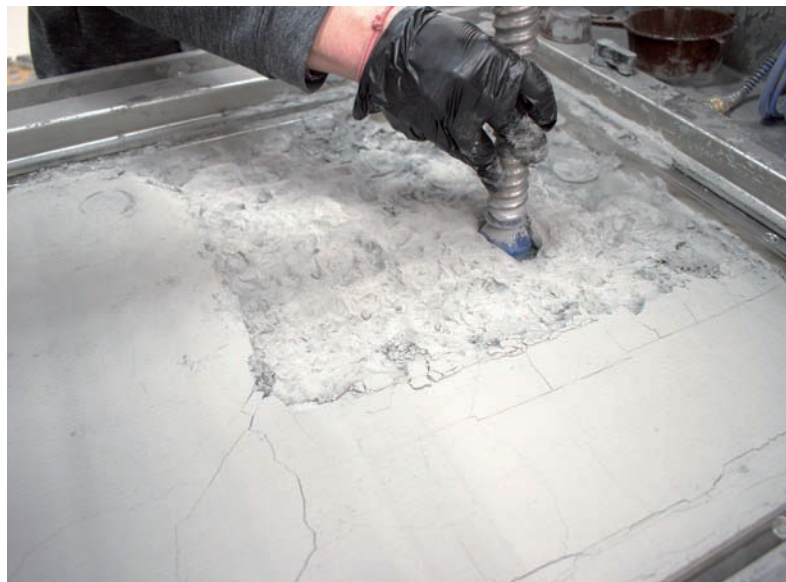
Finálny výrobok sa tlačí do súvislého tlačového boxu, resp. „kopy kovového prášku“.
