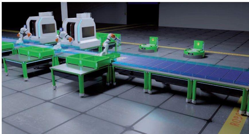
Obr. 8 Digitálne dvojča modulárnej výrobnéj linky [8]
