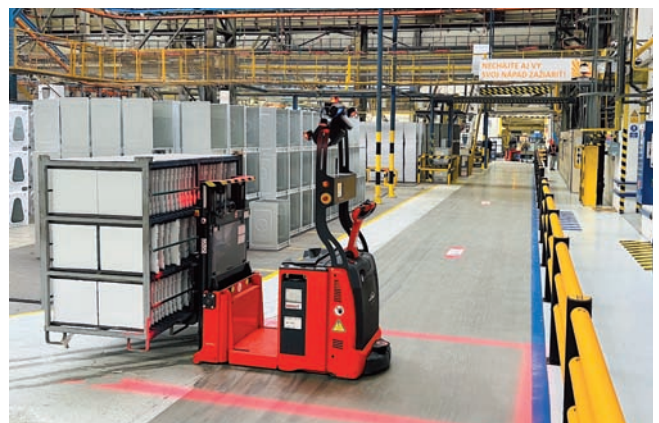
Automaticky navádzaný vozík (AGV) nepotrebuje žiadneho vodiča.
