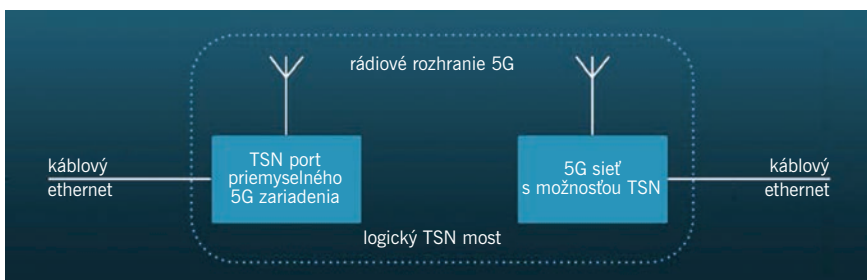
Obr. 9 Port TSN ako súčasť logického mosta TSN
