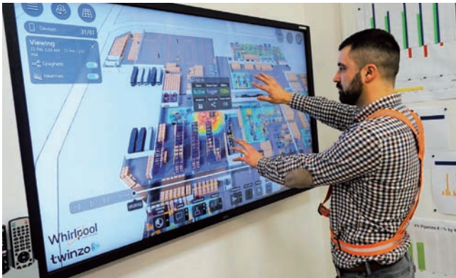
Digitálne dvojča sa skladá z niekoľkých modulov a vrstiev, pričom ponúka aj pohľad na vybrané ukazovatele KPI.
