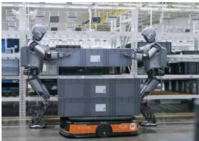
Dva spolupracujúce humanoidné roboty Walker S dokážu bezproblémovo spolupracovať pri plnení úloh s autonómne navádzanými vozíkmi.
