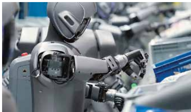
Vďaka integrácii rôznych koncových akčných členov môže Walker S Lite vykonávať úlohy, ako je manipulácia s predmetmi, kontrola kvality, triedenie, manipulácia s chemikáliami a montáž.
