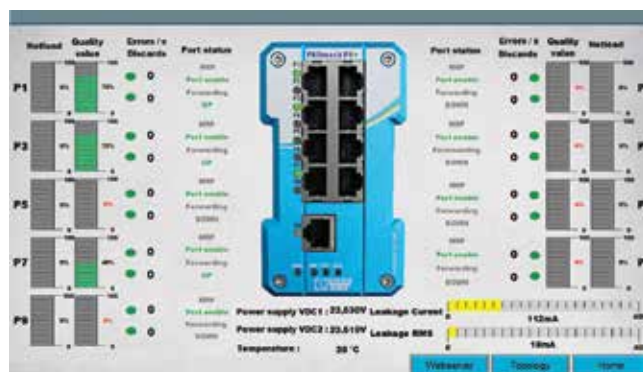
Integrácia do TIA Portal a zobrazenie diagnostických údajov v HMI
