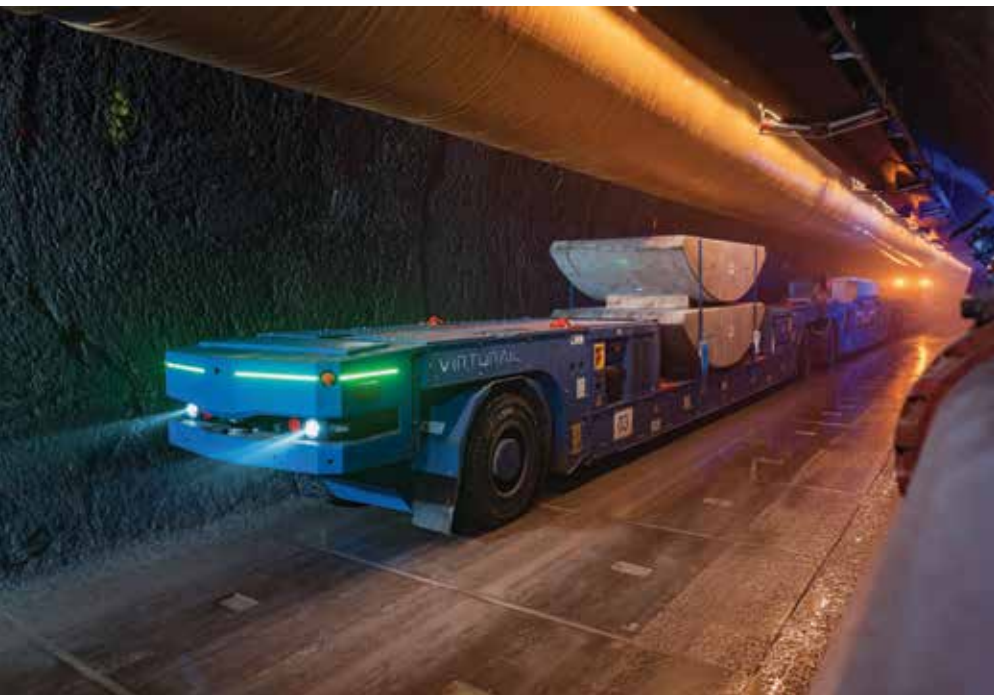
Obr. 1 Vďaka najmodernejšej riadiacej technike a snímačom zvládajú čisto elektricky poháňané automatizované servisné vozidlá (ASV) od spoločnosti VirtuRail trasy na zásobovanie podzemných stavieb presne po jazdnej dráhe bez mechanických koľajových vedení. (Foto: VirtuRail)
