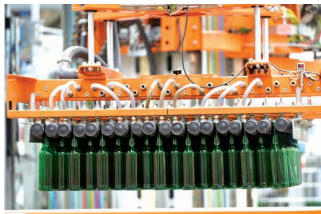
Na prenos fliaš sa používa automatický paletizačný stĺp s trubicovou hlavicou.
