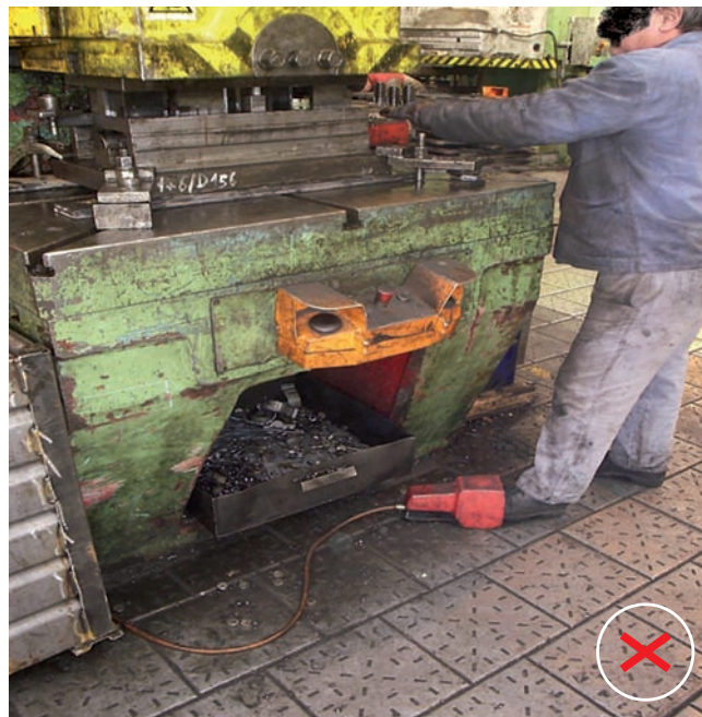
Obr. 4 Nebezpečný pracovný postup pri obsluhu lisu
