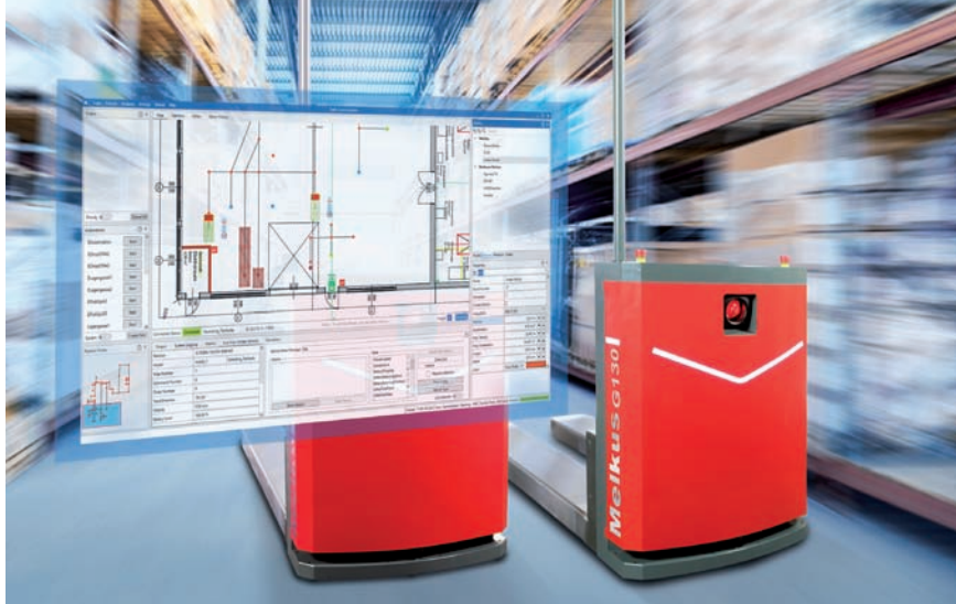
Obr. 4 SIGMATEK Traffic Control System (TCS) umožňuje integráciu AMR bez ohľadu na ich značku do bežných systémov AGV, ako aj ich prepojenie s okolitými IT a automatizačnými systémami.
