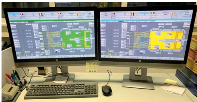
Vizualizácia taviacich agregátov pomocou systému SCADA
