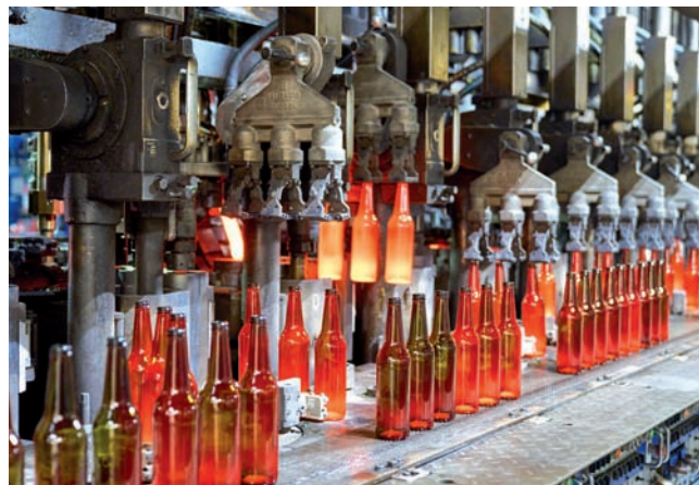
Krátko po vytvarovaní fliaš putujú sklárskej výroby do chladiacej pece.
