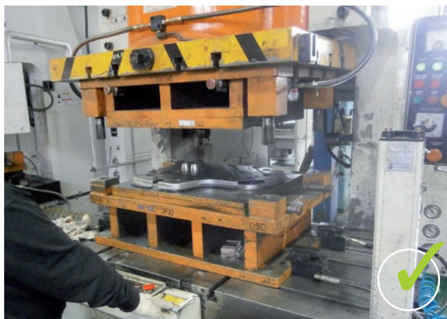
Obr. 5 Pracovný priestor lisu s ochranným zariadením
