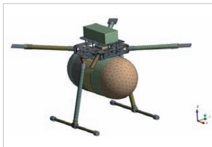
Obr. 2 Sieť konečných prvkov modelu pre PC mechanické analýzy
