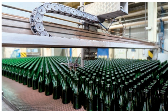
Nástrek polyetylénu na výrobky zvyšuje odolnosť proti oderu.
