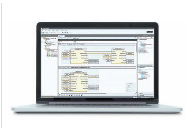
Obr. 2 Příklad: konfigurácia zariadenia IO-Link Safety v prostredí PLCnext Engineer v otvorenom ekosystéme technológie PLCnext
