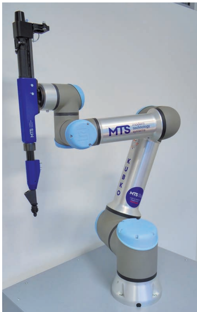
Kompaktná skrutkovacia jednotka MTS umiestnená na kolaboratívnom robote UR5
