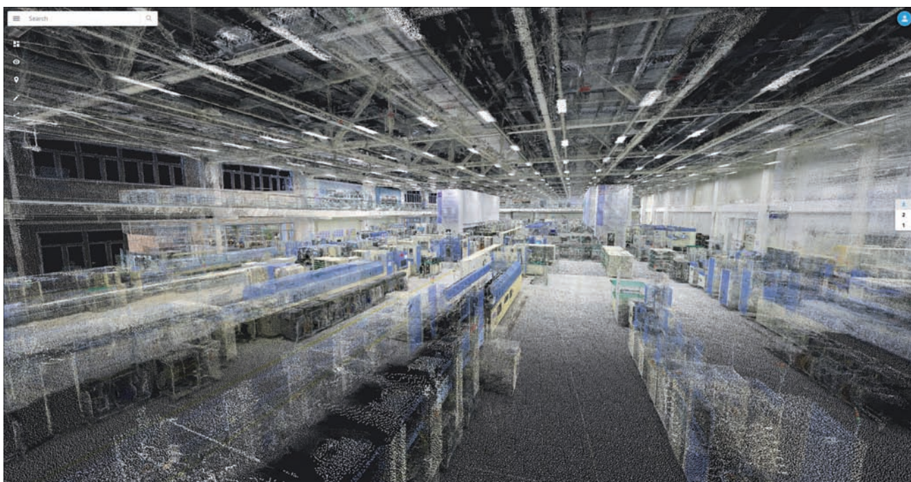
Mračno bodov továrne Siemens generované systémom NavVis Indoor Mobile Mapping System M6
