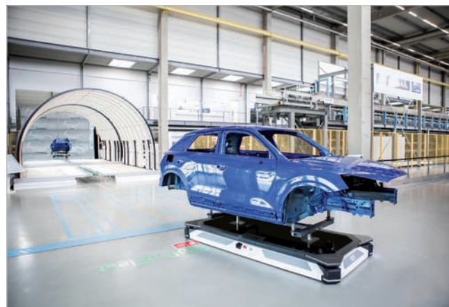
Karoséria umiestnená na autonómne navádzanom vozíku (Zdroj: Dürr Group)
