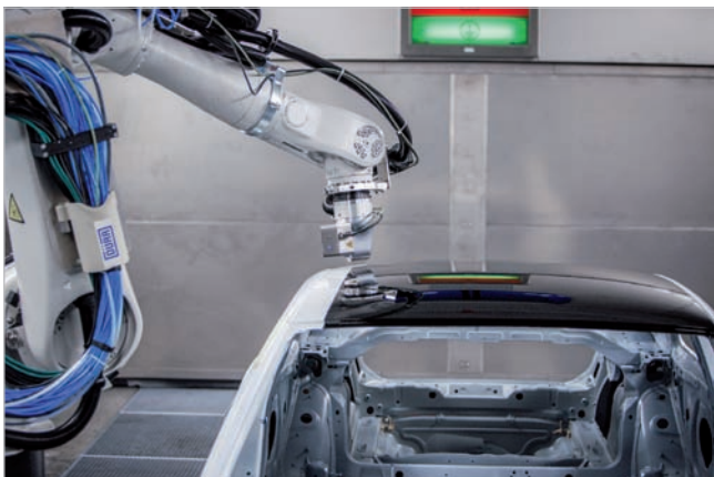
V novej lakovni budúcnosti skupiny Dürr Group sa na lakovanie využívajú roboty vybavené riešením EcoPaintJet. (Zdroj: Dürr Group)
