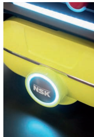
Jednotka NSK s priamym pohonom kolesa vydáva oveľa menej hluku ako konvenčné AGV.
