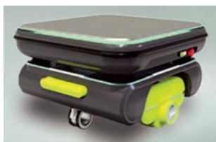
Jednotka NSK s priamym pohonom kolesa zabudovaná do autonómneho servisného robota
