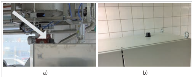
Od antény k anténe. Anybus Wireless Bolt namontovaný na vrchu pekárenského stroja (a) komunikuje cez bluetooth s druhým Wireless Bolt na vrchu riadiacej skrine (b).
