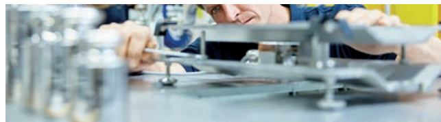
Obr. 34 Nastavenie dorazov na plošinovej váhe s tenzometrom
