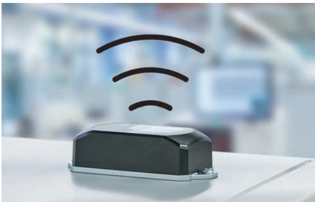
Obr. 3 WLAN 1100 je cenovo efektívne kompletne riešenie s integrovanou anténou a bezdrôtovým modulom, ktoré umožňuje jednoduchú inštaláciu vysokorychlostnej stabilnej siete WLAN na strojné zariadenie.
