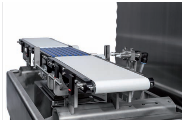
Obr. 38 Nastavenie rovinnosti dopravníkov na dynamickej váhe
