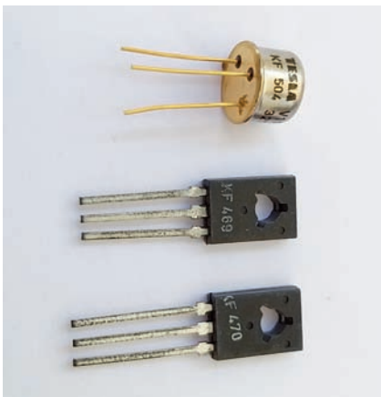
Obr. 2 Pre čiernobiele televízory stačili pre videozosilňovače tranzistory KF 504, pre farebné širokouhlé prijímače už boli potrebné komplementárne páry KF 469 + KF 470
