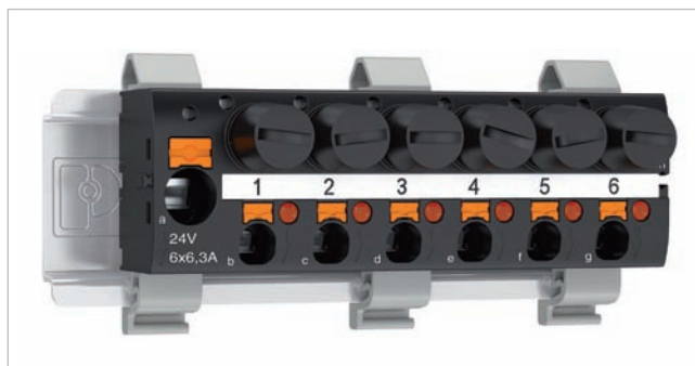
Obr. 4 Nový držiak poistiek PTFIX ponúka najkompaktnejšie rozmery so šiestimi samostatne chránenými vetvami s menovitým prierezom 4 mm 2 a voliteľnou signalizáciou prepálenej poistky.
