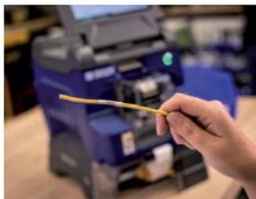
Zariadenia sú schopné spracovať káble s rôznym priemerom a tlačiť rôzne typy informácií, od sériových čísel po čiarové či QR kódy a zodpovedajú tak dynamickým potrebám modernej výroby.
