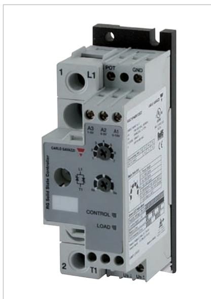
Proporcionálny spínač výkonu s analógovým vstupom RGC1P23V12ED s výstupom 0 – 10 V alebo 4 – 20 mA, čo zjednodušuje regulačnú slučku a umožňuje maximálne využitie energie vyrobenej vo fotovoltaických systémoch.
