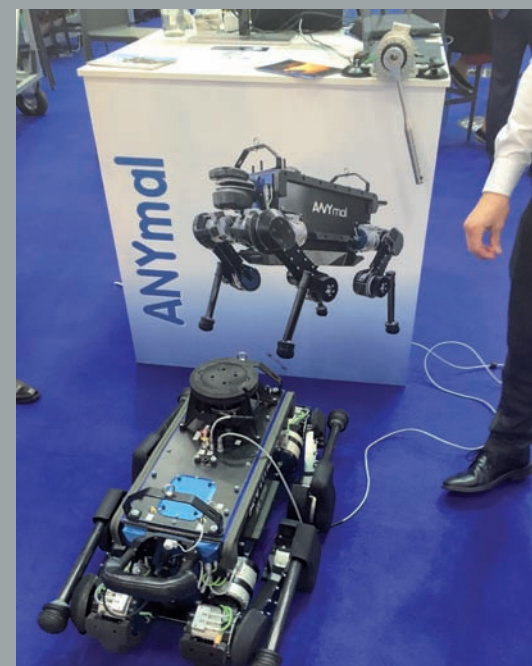
Unikátna konštrukcia chodiaceho robota Anymal
