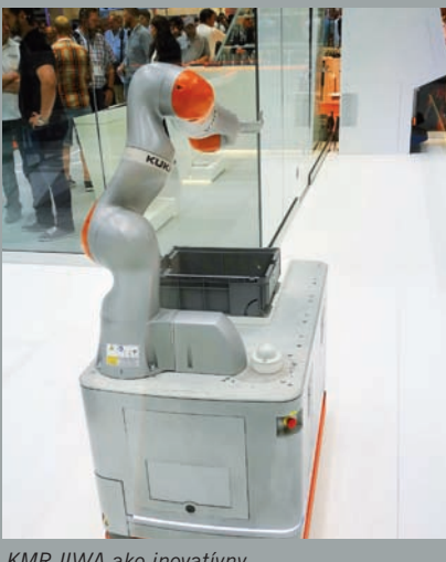
KMR IIWA ako inovatívny koncept mobilného manipulátora pre prostredie s človekom
