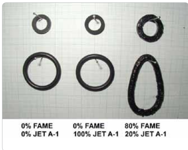
Obr. 3 Zmena rozmerov a objemu sledovaných gumových tesnení po dlhodobom pôsobení zmesi biopaliva MERO a leteckého petroleja JET-A1
