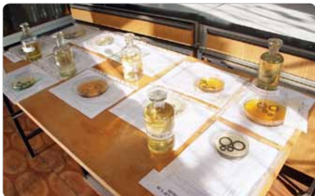
Obr. 2 Sledovanie vplyvu rôznych koncentrácií zmesí biopaliva MERO a leteckého petroleja JET- A1
