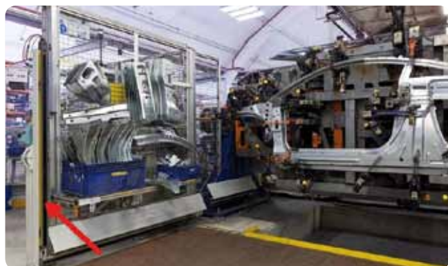
Obr. 1 Vkladanie častí karosérie auta do držiakov v rámci robotickej bunky sa vykonáva ručne. Preto je potrebné, aby bol celý prístupový priestor chránený vo vertikálnom aj horizontálnom smere. Šípka ukazuje na bezpečnostné svetelné závery COMPACTplus od Leuze electronic.
