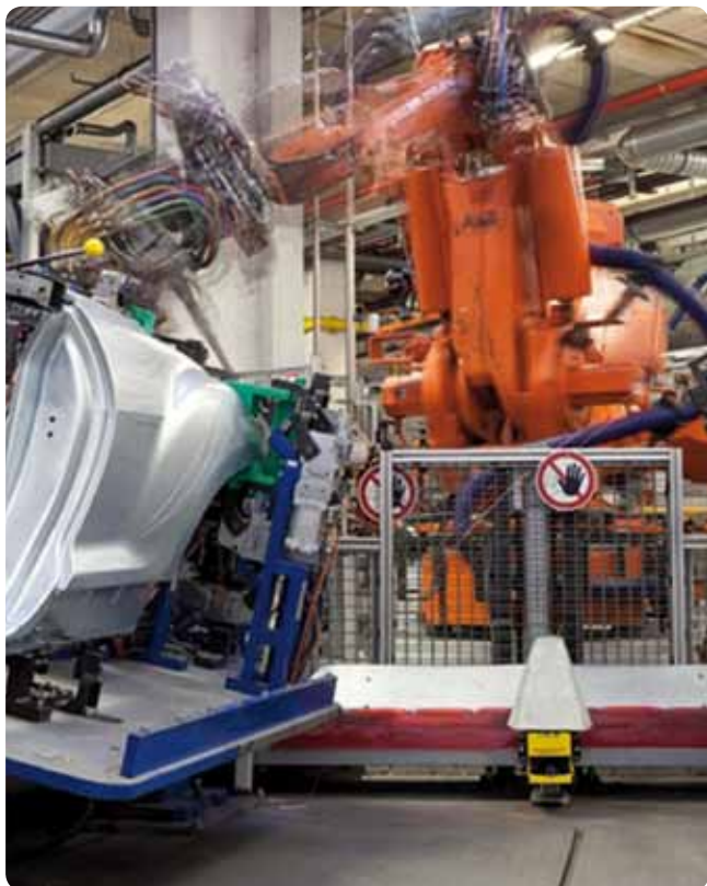
Obr. 3 Montáž bočných prvkov karosérie Peugeot RCS sport coupé, počas ktorej obsluhujúci personál namontuje ručne ľavé a pravé krídlo spoileru, vyžaduje veľmi presné a jasné zadefinovanie bezpečného systému prístupu.
