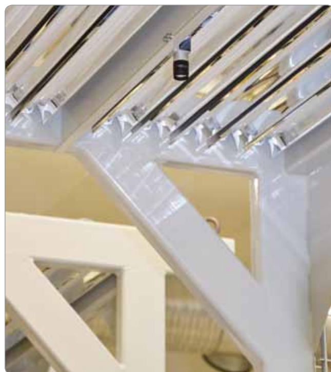
Obr. 2 Kamera shora snímá dopravníkový pás
