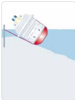
Obr. 1 Vrak lode Costa Concordia, ktorý ležal pod vodou pod uhlom 65°, bol zaistený proti zošmyknutiu a úplnému potopeniu pomocou kotevných blokov a reťazí.
