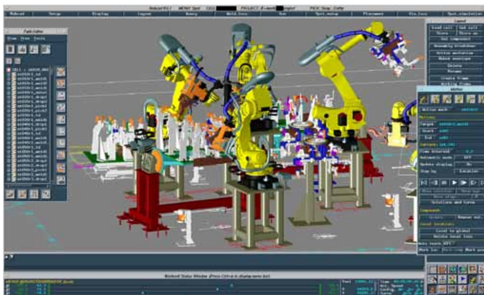
Obr. 2 Návrh usporiadania pracoviska v module Tecnomatix Process Simulate
