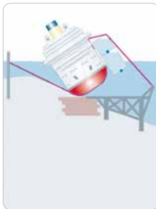
Obr. 3 Costa Concordia bola opatrne natočená do horizontálnej polohy pomocou hydraulických navijakov a riadeného zaplavovania komôr na ľavoboku.
