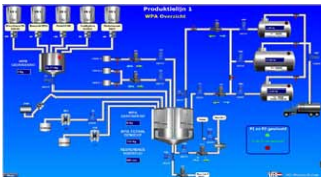
Obr. 2 Vizualizácia procesu miešania zmesi materiálu SMC (linka 1)
