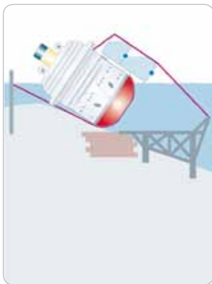
Obr. 2 Potápači postavili podmorskú plošinu alebo tzv. falošné dno, na ktorom sa bude loď otáčať. K ľavoboku lode boli pripojené komory a ocelové laná.
