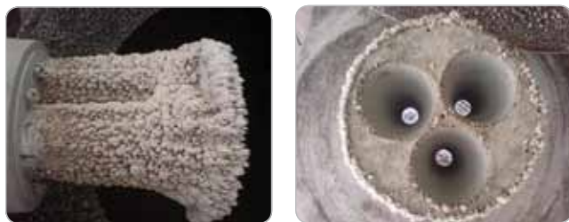
Obr. 2 Fotografia vlnovodov a membrán snímačov ukazuje, že aktívne časti zostávajú vďaka samočistiackej schopnosti akustického signálu funkčné aj pri nasadení v aplikáciách s vysokou prašnosťou.
