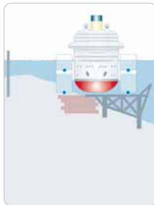
Obr. 4 Teraz bolo možné pripevniť komory aj na pravobok lode zo strany pobrežia.
