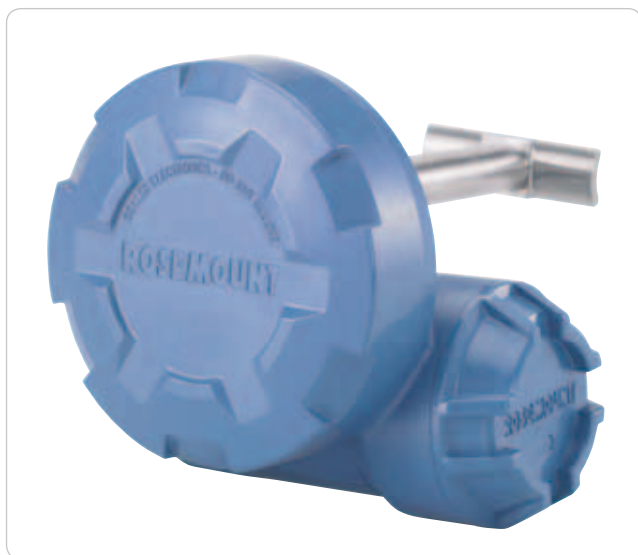
Obr. 2 Rosemount 708 sa jednoducho pripevní k parnému potrubiu a bezdrôtovo posíla prostredníctvom komunikačného protokolu WirelessHART do DCS údaje o frekvencii zvuku a o teplote
