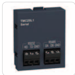
Obr. 1 Zasunutím tohto špeciálneho modulu do tela PLC Modicon M221 dôjde k rozšíreniu jeho komunikačných schopností o druhú sériovú linku (prvú má zabudovanú v základe).
