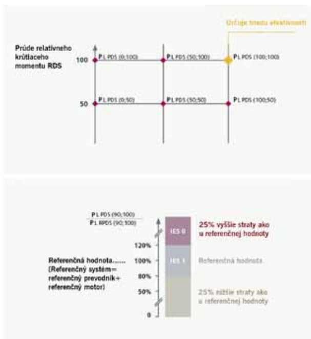
Obr. 2 Trieda energetickej účinnosti meničov frekvencie CMD a triedy energetickej účinnosti motorických systémov PDS (Siemens AG)
