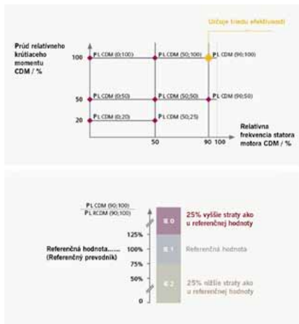
Obr. 2 Trieda energetickej účinnosti meničov frekvencie CMD a triedy energetickej účinnosti motorických systémov PDS (Siemens AG)
