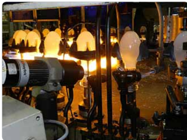
Obr. 2 Detail procesu zatavenia banky
