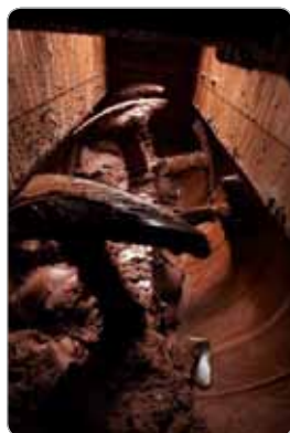
Zušľachťovanie čokoládovej zmesi v conche stroji
