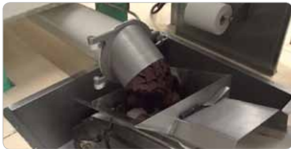
Zahusťovanie v závitovkovom dopravníku
