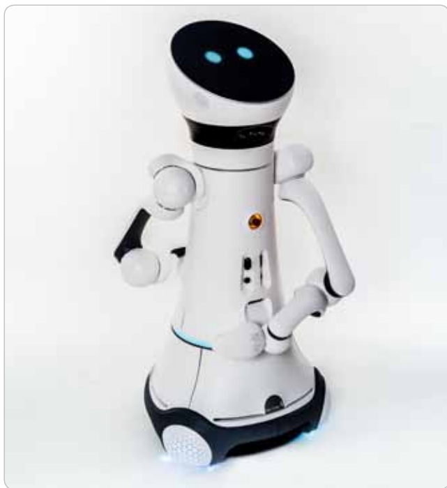
Obr. 2 Štandardný dizajn Care-O-bot® 4 umožňuje nastavenie individuálnej robotickej platformy pre rôzne aplikácie, čo rozhodne znižuje náklady pre vývoj nových servisných robotických riešení.
