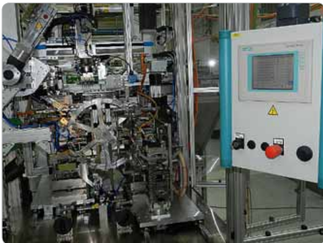
Obr. 1 Technologický uzol – depaletovač + bodovanie privodov na horák (v popredí operačný panel Siemens)
