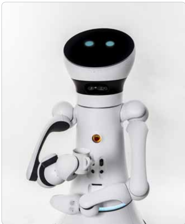
Obr. 4 Štandardizované SCHUNK Powerball Lightweight Arm umožňuje s jednorukovou rukou rôzne kombinované uchopovacie operácie.
