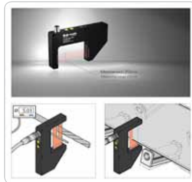
Obr. 2 Aplikácie LLGT 081 snímača di-soric
