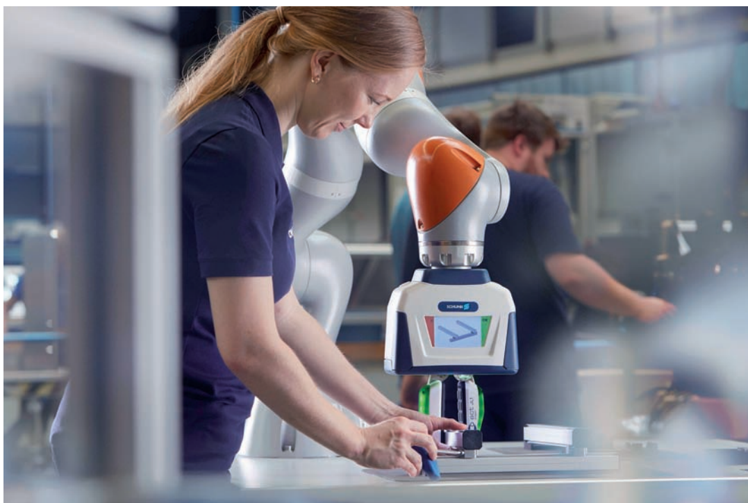
Na Hannover Messe spoločnosť SCHUNK ukáže, ako možno integrovať čiastkové aspekty svojho nositeľa technológií SCHUNK Co-act JL (na obrázku) v štandardnom uchopovači. Tento uchopovač bude so svojou uchopovacou silou 450 N nastavovať štandardy v oblasti kolaboratívnej manipulácie.
