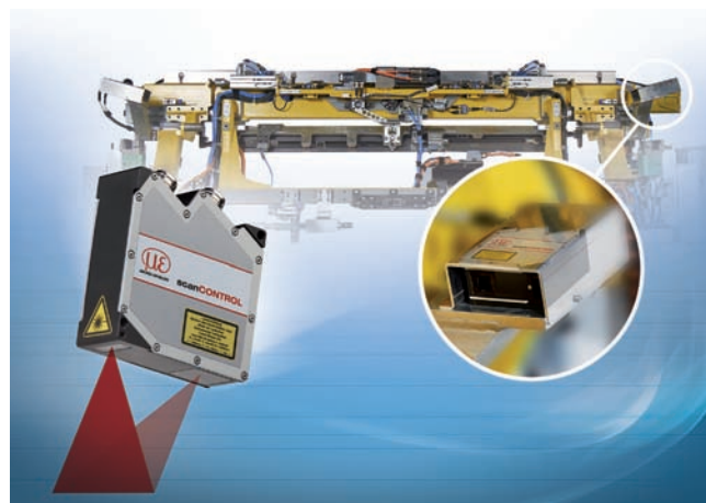
Riadenie polohy montáže kokpitu pomocou profilových skenerov
