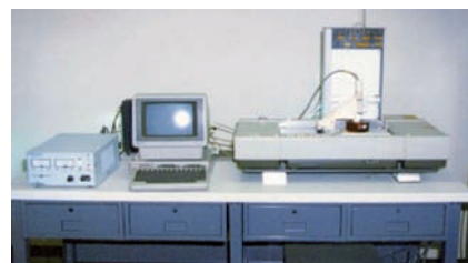
Zariadenie SLA-1 využívajúce princíp stereolitografie
